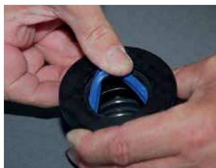
Těsnicí kroužky (manžety) oválně vytvarovat a axiálně ohnout. Usadit na místo drážky a po obvodu zatlačit, až těsnicí kroužek zapadne do drážky. U těsnicích manžet s vnitřním opěrným kroužkem (např. typ S 621, S 652, atd.) vsadit nejprve těsnicí část a poté opěrný kroužek stejným způsobem. Tento postup lze u velkých sérií snadno automatizovat pomocí přípravků.
