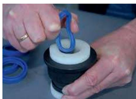
3) Poté vytvarovat těsnění a tlačit ho otvorem v zaváděcí objímce proti zarážce.
