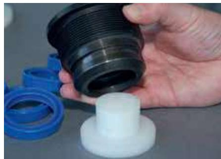
1) Víko (hlavu) válce pro montáž pístnicového těsnění nasadit na zarážku, která uvnitř na spodní hraně drážku uzavře (zaslepí).
